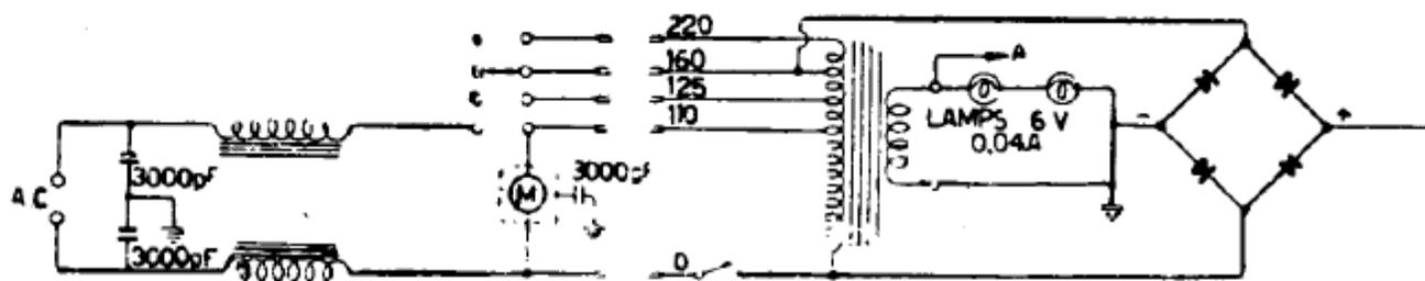
SICART-EMERSON - Mod. 1015. Apparecchio di minime dimensioni con sola gamma onde medie e con due finali in controfase.
